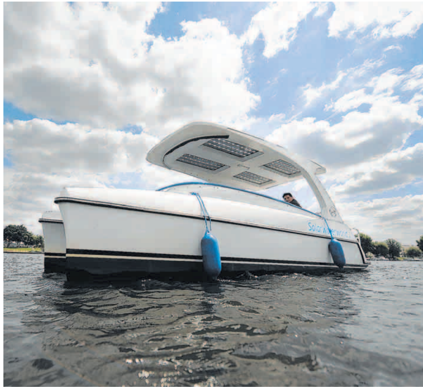
Auf dem Dach der Suncat 23 sind Fotovoltaikzellen ausgelegt, die das sieben Meter lange Zweirumpfboot (Katamaran) mit Strom versorgen. Bis zu sieben Personen haben Platz, Tim Schultze (kl. Foto) vermietet so ein Solarschiff ab 150 Euro pro Tag
